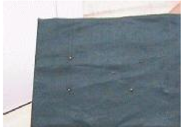
Figura 3: Placa de compensado forrada e com sensores
