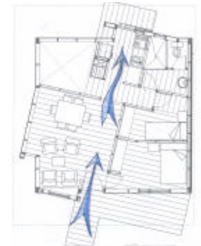
Diagrama de ventilación cruzada en la vivienda
