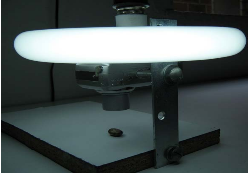
Figura 5. Montaje para el análisis de imágenes.
