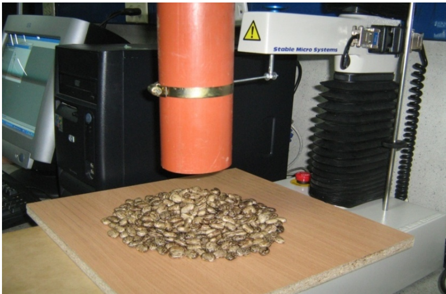
Figura 9. Montaje experimental para evaluar el ángulo de reposo.
