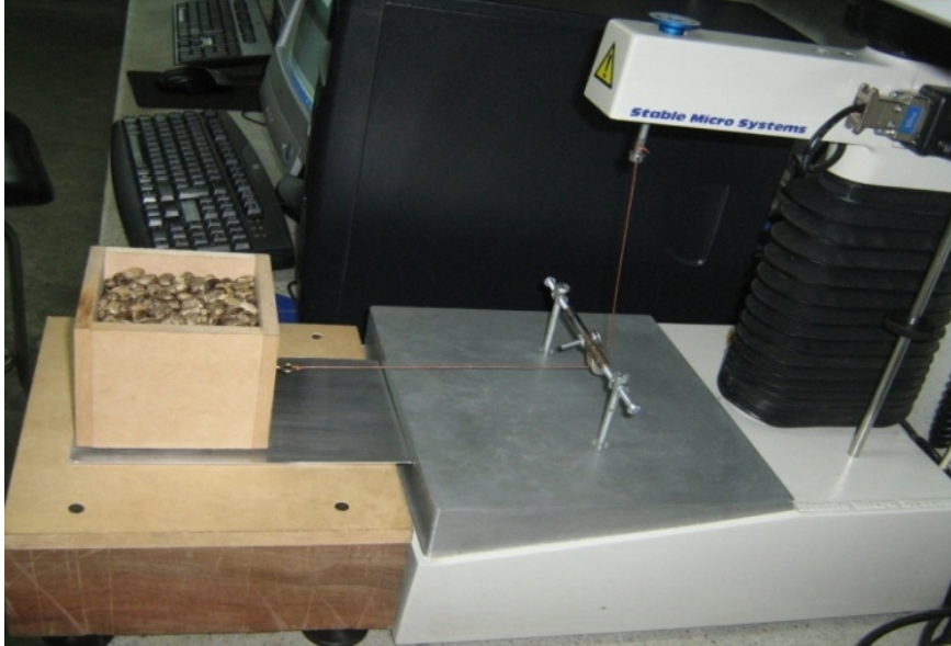
Figura 8. Montaje experimental para evaluar el coeficiente de fricción
