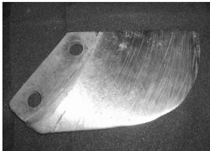
Herramienta con desgaste severo
