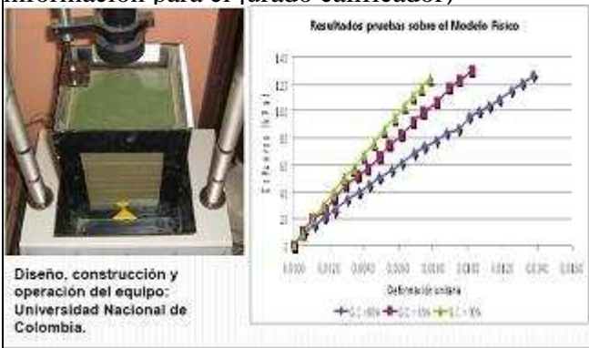
Pruebas de carga – modelo físico de laboratorio
