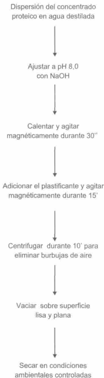
Figura 1. Línea tecnológica para la preparación de películas a partir de concentrado proteico de haba
