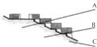
Esquema 2. Corte de mala disposición de viviendas en contra de la pendiente. Elaborado por López y López. A: Las viviendas no tienen acceso por la vía plana. B: Las viviendas se implantan contra la pendiente, generando gran movimiento de terreno. C: Las fachadas no tienen vanos, no disfrutan de la visual y degradan la imagen de la ciudad.
