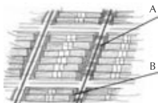
Esquema 1. Mala disposición de viviendas en contra de la pendiente. Elaborado: López y López. A: Las viviendas tienen acceso por la vía plana. B: La vía plana es disfrutada por menos viviendas.
