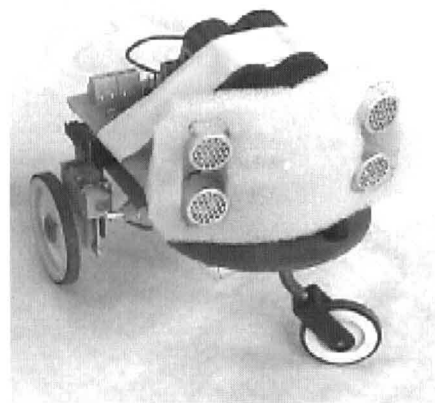
Figura 1. Robot programable con sensores de ultrasonido y un algoritmo de reacción para evitar colisiones durante su navegación.
