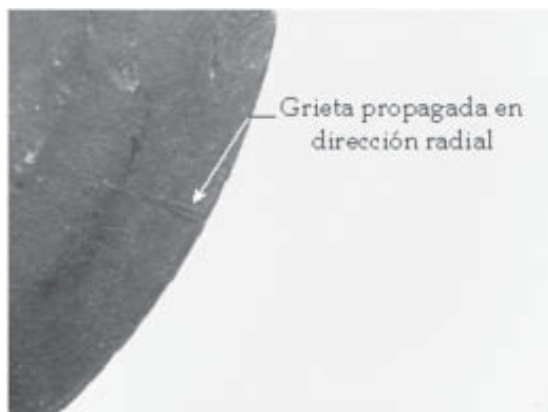
Figura 5. Ubicación de las grietas en la cabeza de la válvula.
