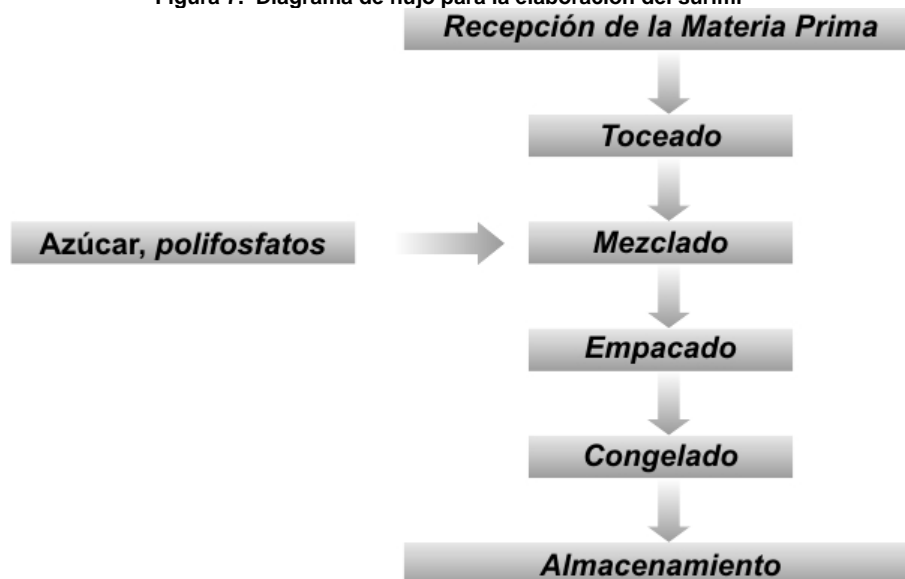
Figura 7. Diagrama de flujo para la elaboración del surimi
