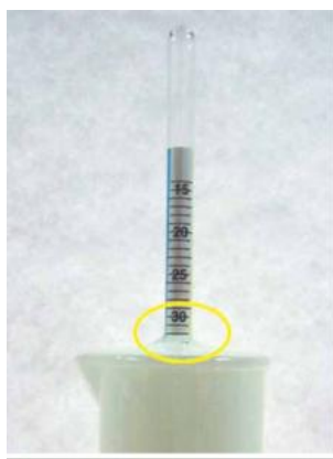
Figura 4: Lectura de la densidad en el termo lactodensímetro.
