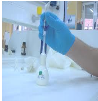
Figura 2: Determinación de la densidad ó peso específico con el picnómetro.
