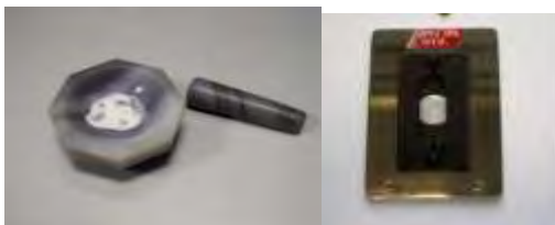
Figura 28 Manejo de la muestra para la toma de FTIR del esmalte. Fotografías tomadas en el laboratorio de espectrometría de infrarrojos en la Facultad de Química de la Universidad Nacional.
