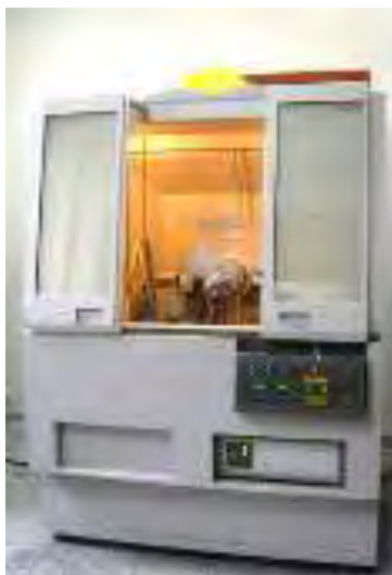
Figura 30 Difractómetro Panalytical X'Pert PRO MPD® del Laboratorio de Difracción de RX del Departamento de Física de la Facultad de Ciencias de la Universidad Nacional de Colombia.
