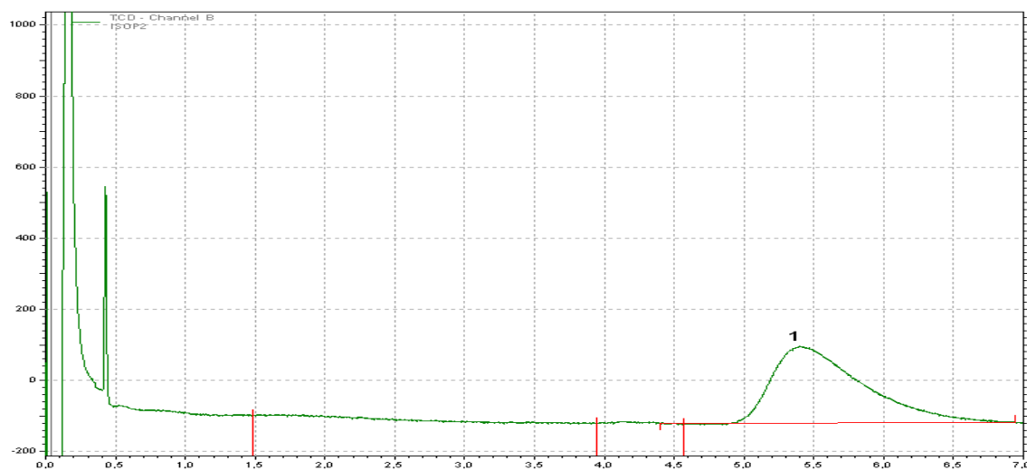
Figura 16A. Cromatograma de alcohol Isopropílico a una concentración de 841 ppm.
