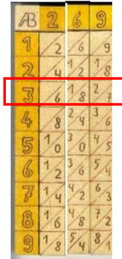
Figura 1-9: Multiplicación utilizando los huesos de Napier.
